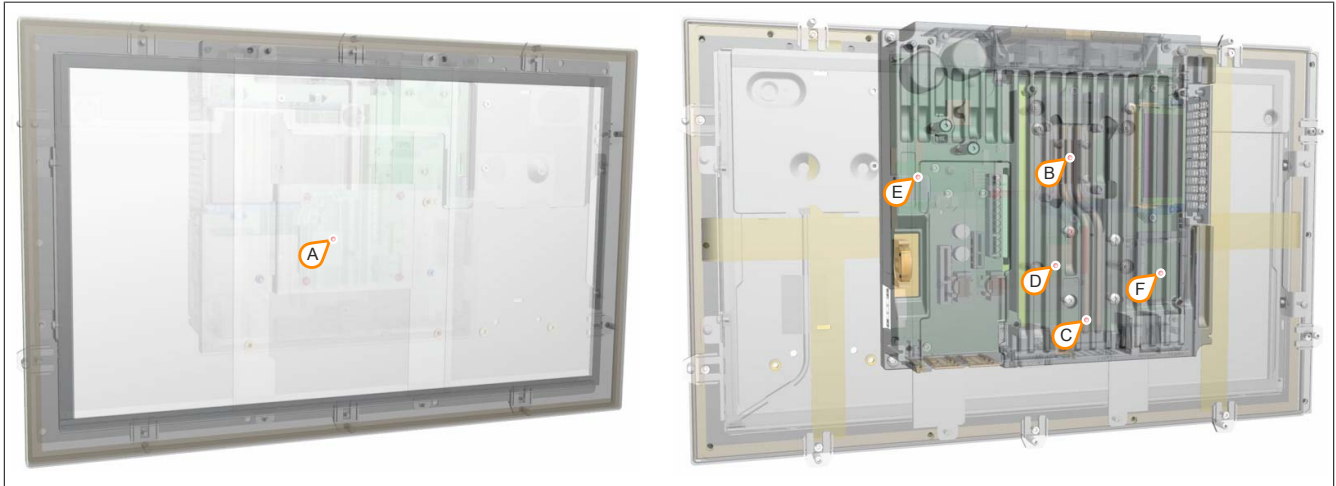
Abbildung 14: Temperatursensorpositionen - Panel PC 900
