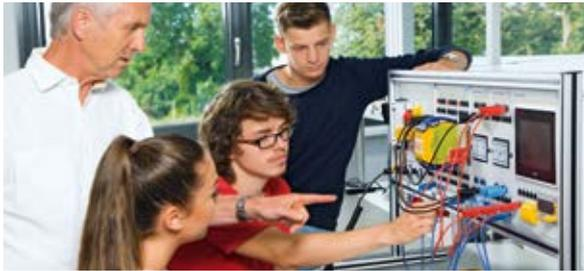
PES bestehen aus verschiedenen, übersichtlich auf einem Bedienfeld angeordneten Sicherheits- und Automatisierungsfunktionen. Mit den Schulungssystemen können Auszubildende, Studenten und Schulungsteilnehmer das Programmieren von Steuerungen oder das Realisieren von Sicherheitsfunktionen von Maschinen und Anlagen realitätsnah erlernen.
