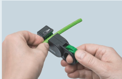
Leitungsende mit dem FastConnect Stripping Tool absetzen
