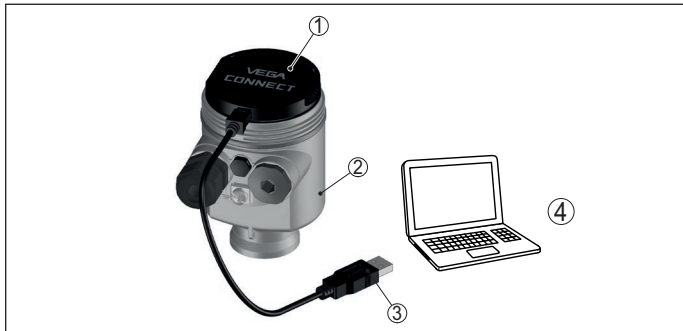
Abb. 54: Anschluss des PCs via VEGACONNECT und USB
