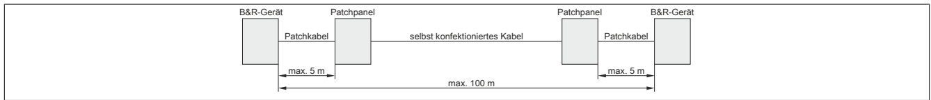
Abbildung 43: Verkabelung mit selbst konfektioniertem Kabel
