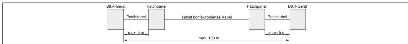
Abbildung 53: Verkabelung mit selbst konfektioniertem Kabel
